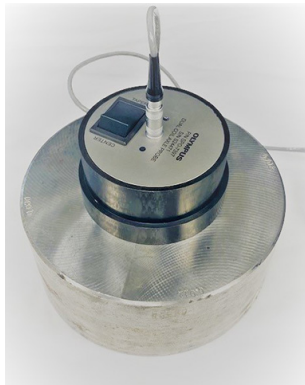
Configuração da sonda para inspecionar defeitos em um centro de eixo ferroviário
